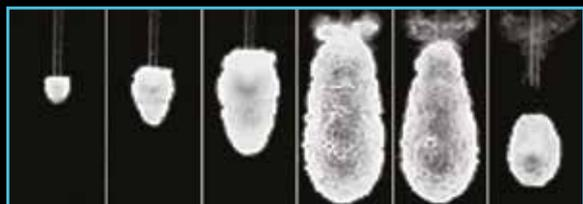
Dinamica della bolla con Vapor Tunnel®
